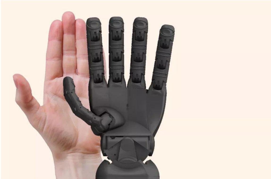
RH8D 具有 19 个自由度，包括对侧拇指和一个完整的球形手腕关节。另外，三段手指由智能执行器独立控制。欠驱动设计旨在实现用户精细控制的同时，还能兼顾对不同形状物体的自适应。
