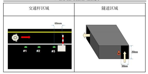
(注:车道线由宽度为2-3cm的黄色和白色标识线组成,基于机器人的朝向,黄线在左,白线在右;泊车位上的泊车虚线段长度为3cm,每两段泊车虚线段之间的距离为2cm;隧道任务不允许使用灯光)
